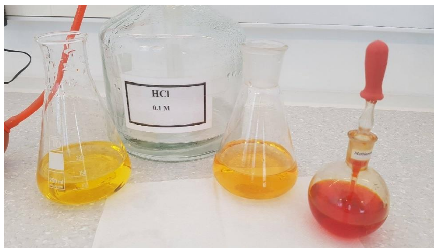
Slika 4. Prijelaz boje kod određivanja karbonatne tvrdoće iz žute u narančastu
