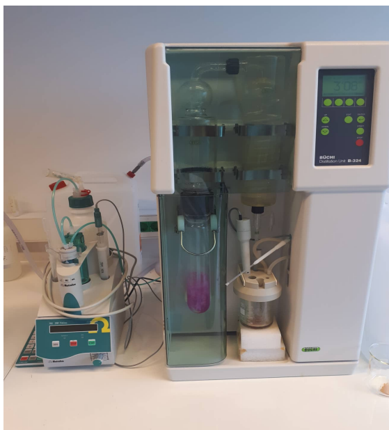
Slika 12. Automatska jedinica za destilaciju.
