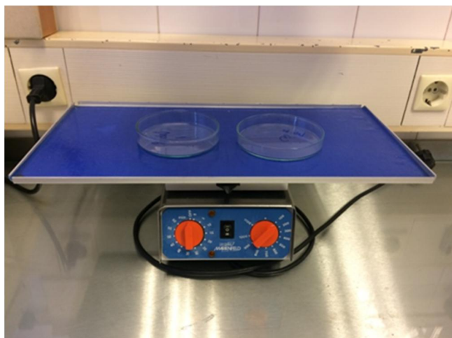
Slika 6. Maceracija uzorka 5(2) na magnetskoj miješalici
