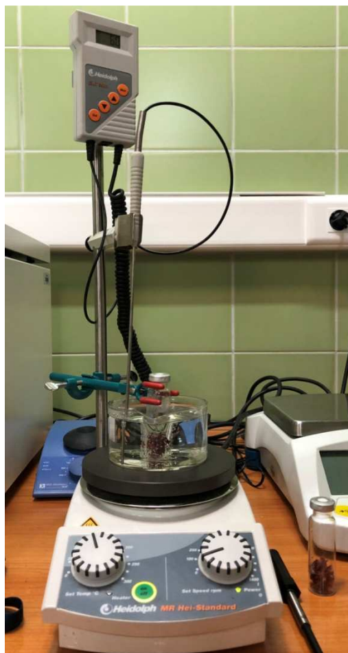
Slika 9. Aparatura za mikroekstrakciju vršnih para na krutoj fazi (HS-SPME)
