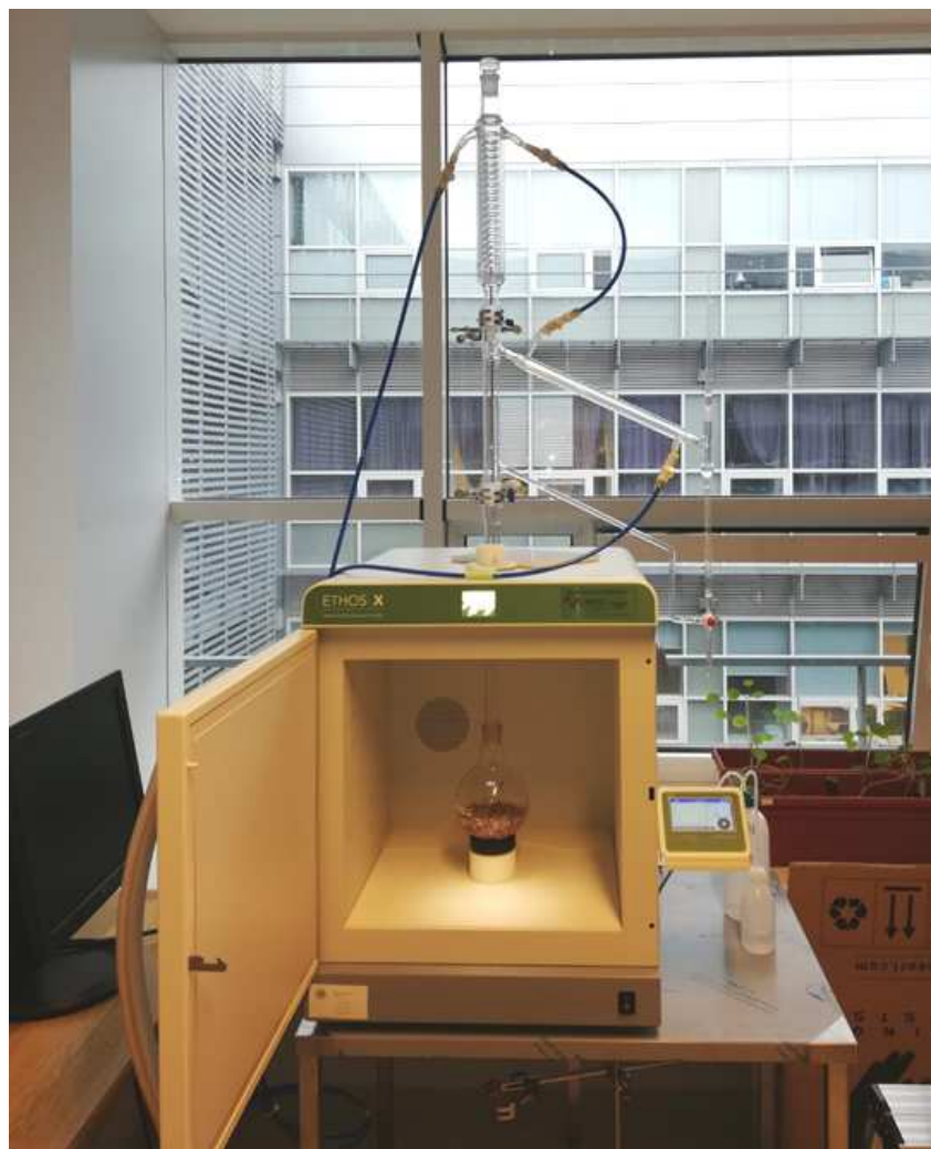
Slika 10. Aparatura za destilaciju potpomognutu mikrovalovima
