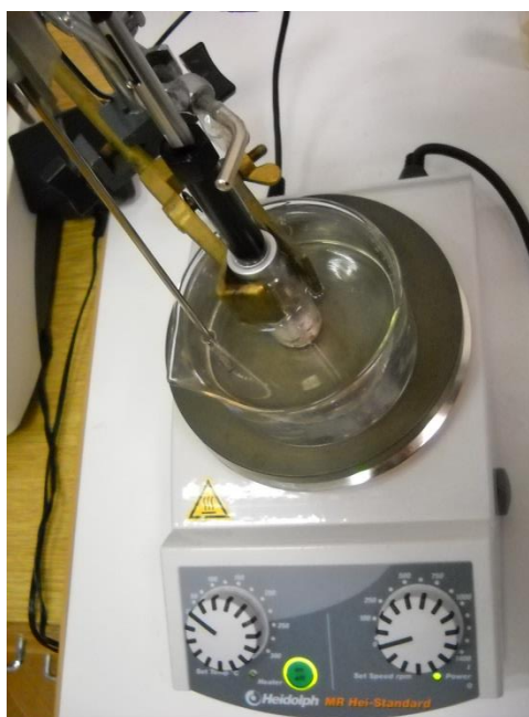
Slika 12. Aparatura za pripremu uzorka za HS-SPME (32)
