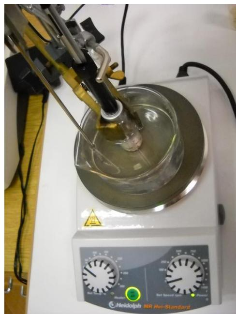
**Slika 12.** Aparatura za pripremu uzorka za HS-SPME (32)
