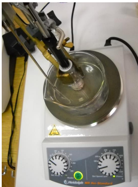
Slika 12. Aparatura za pripremu uzorka za HS-SPME (32)
