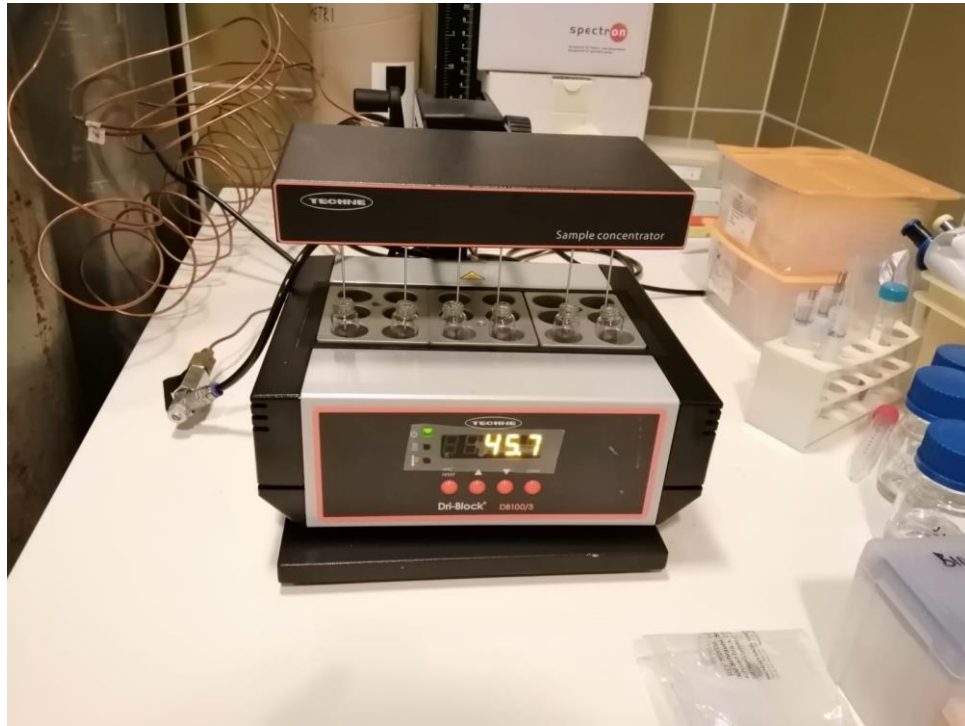
Slika 8. Prikaz uređaja za uparavanje
