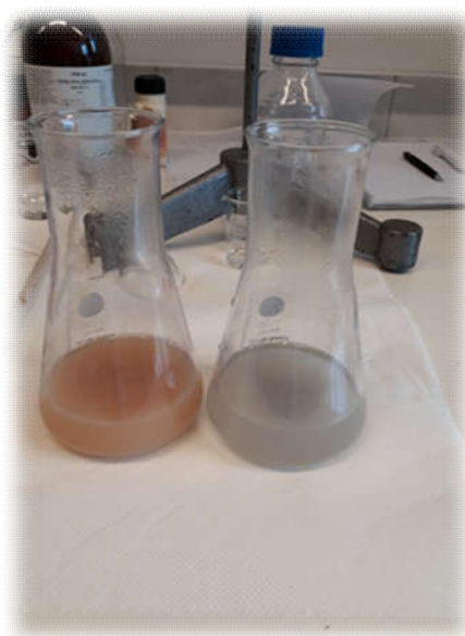
Slika 6. Prikaz završne točke titracije kod Mohr metode
