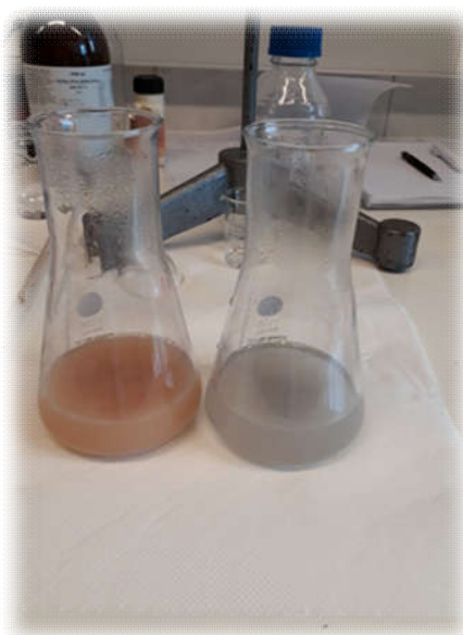
Slika 6. Prikaz završne točke titracije kod Mohr metode
