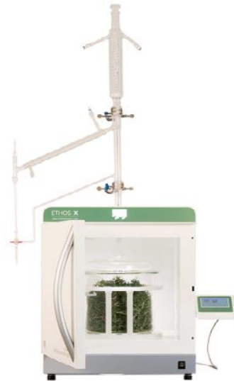
Slika 4. Uređaj za mikrovalnu ekstrakciju 13
