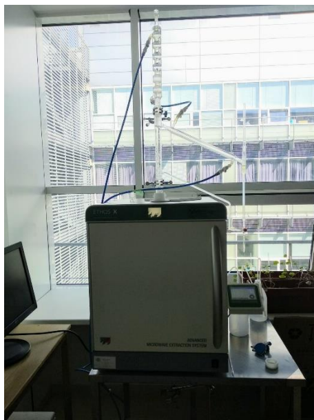
Slika 5. Korišteni uređaj za mikrovalnu ekstrakciju Ethos X (Milestone Srl, Italy)
