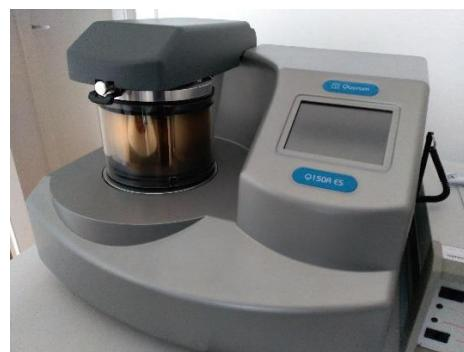
**Slika 15.** Uređaj za nanošenje zlata
