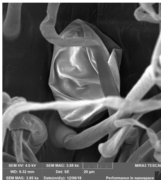
Slika 18. Deformirani spremnik eteričnog ulja
