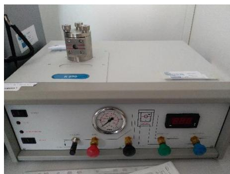
**Slika 14.** Sušilica na principu kritične točke
