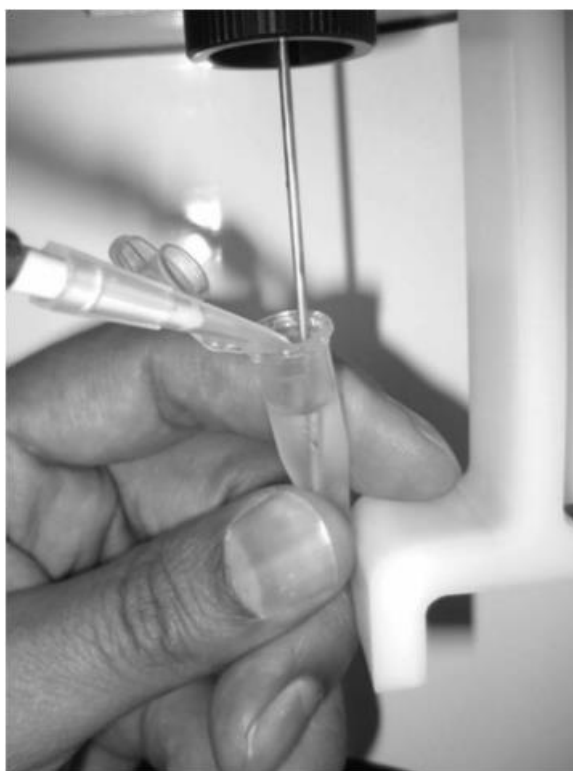
Slika 9: Dodavanje stanica ili reagensa tijekom analize uzorka u Accuri C6 protočnom citometru (14)
