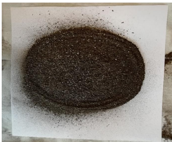
Slika 3.6 Uzorak humusa koji je zalijevan samo s vodenom otopinom bakra
