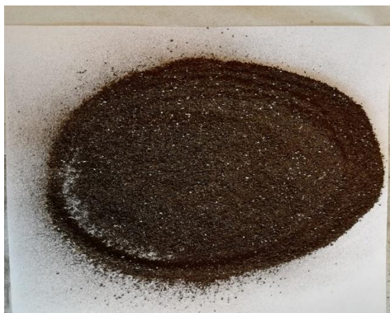
Slika 2.3 Uzorak humusa u koji je dodan humus na koji je adsorbiran bakar
