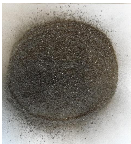
Slika 2.5 Uzorak humusa u koji je dodan zeolit na koji je adsorbiran bakar
