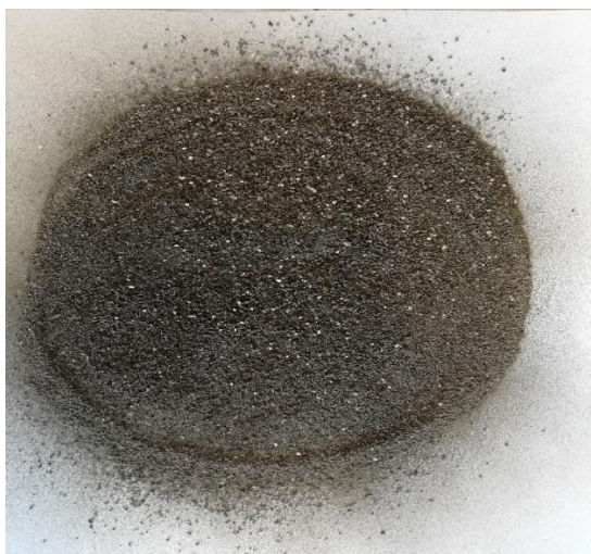
Slika 3.5 Uzorak humusa u koji je dodan zeolit na koji je adsorbiran bakar
