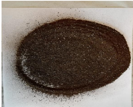
Slika 3.3 Uzorak humusa u koji je dodan humus na koji je adsorbiran bakar
