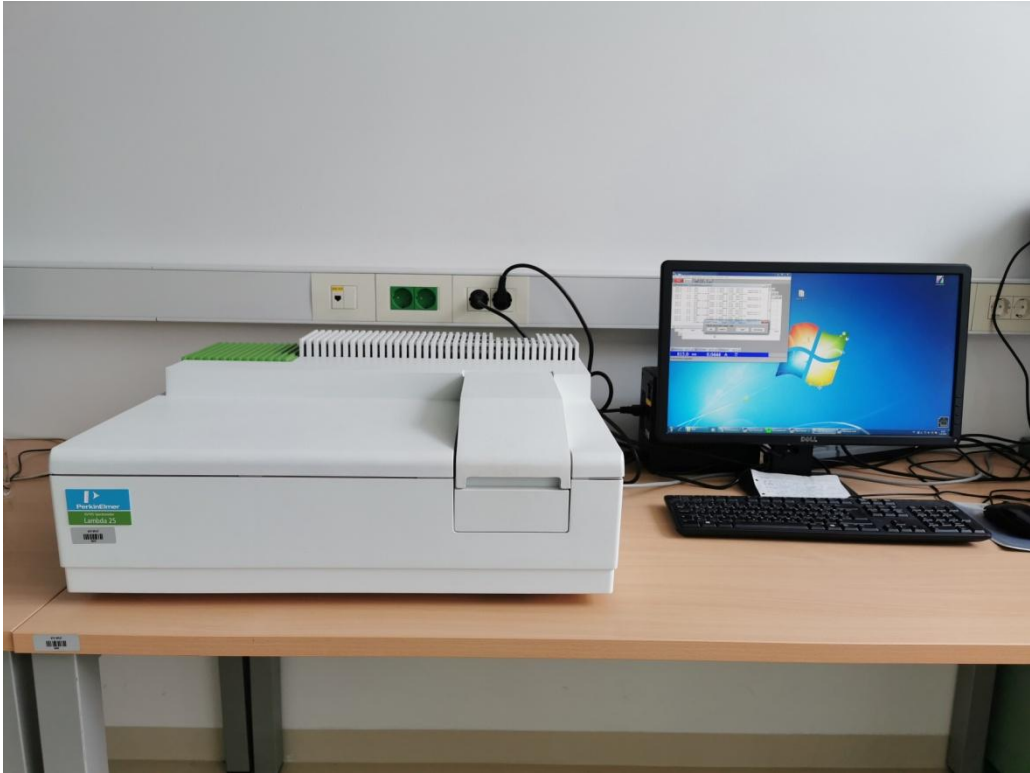
Slika 2.5. Spektrofotometar Perkin Elmer Lambda 25
