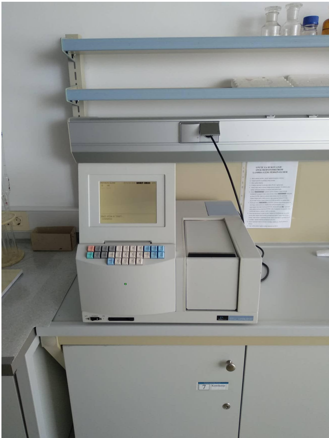
Slika 2.5. Spektrofotometar Perkin Elmer Lambda EZ 201
