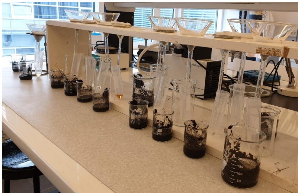
Slika 2.9. Proces filtracije otopina uzoraka
