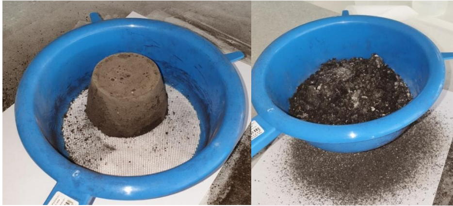
Slika 2.5. Priprema uzoraka tla prosijavanjem
