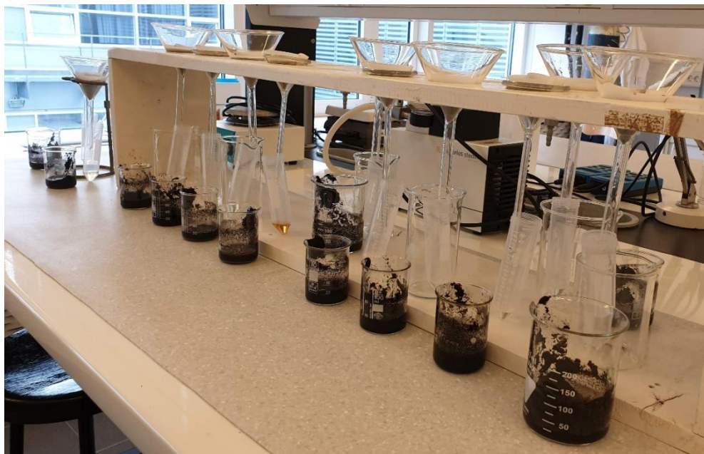
Slika 2.9. Proces filtracije otopina uzoraka
