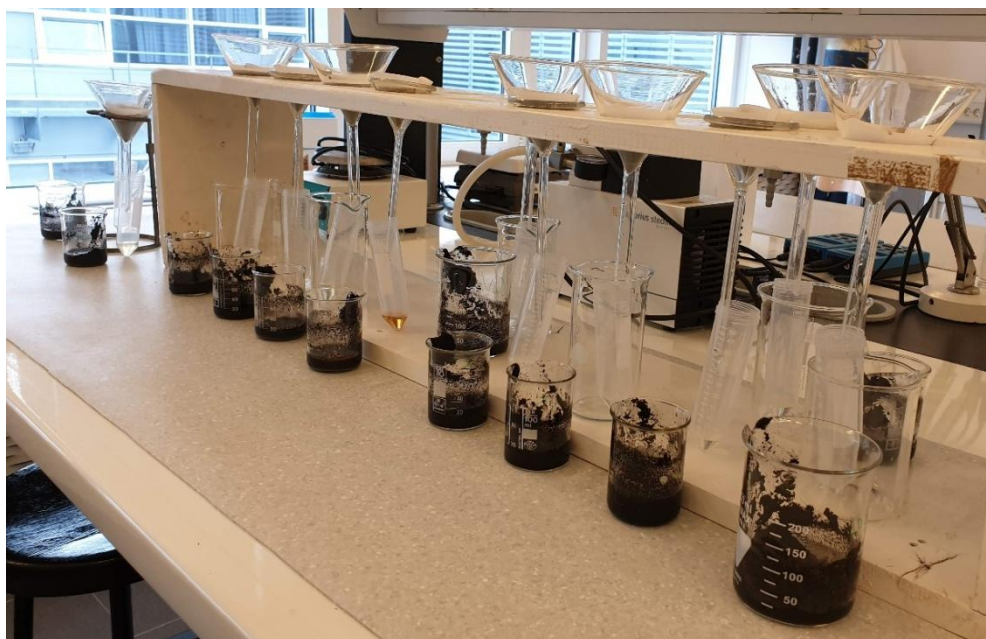
Slika 2.9. Proces filtracije otopina uzoraka
