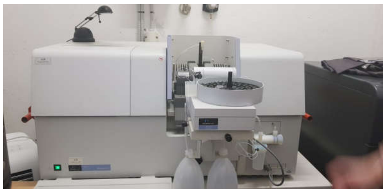
Slika 9. Atomiški apsorpcijski spektrofotometar
