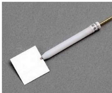
Slika 14. Platinska pločica kao elektroda [26]
