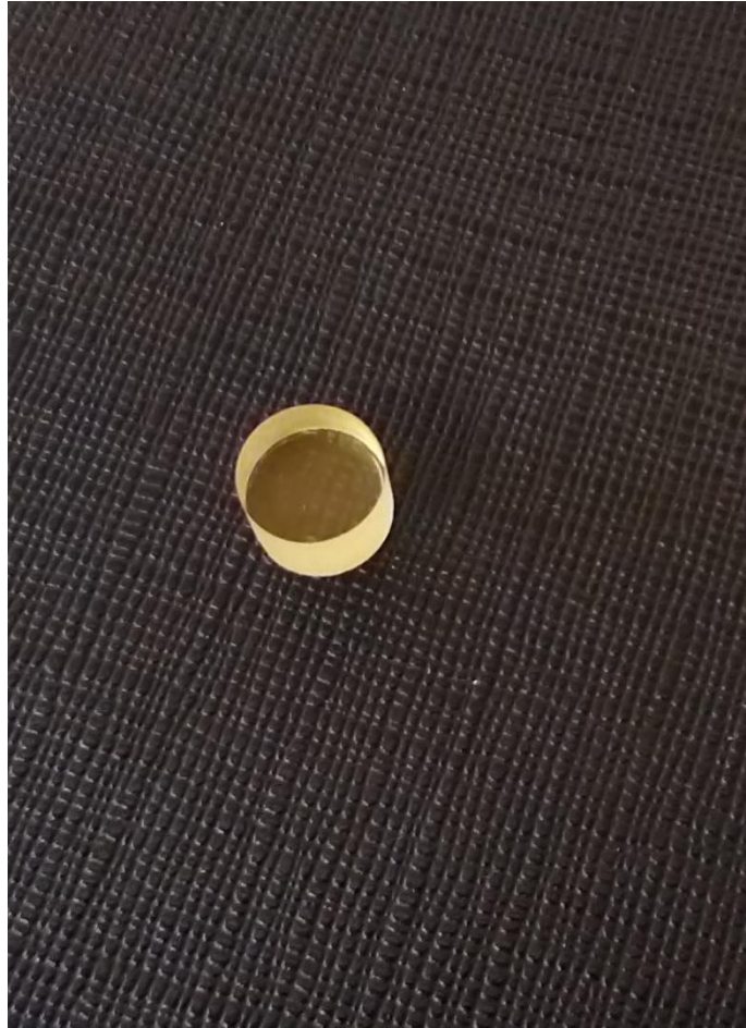
Slika 5. Membrana LaF_3 s udjelom Eu u iznosu od 1%, debljine 8x5 mm
