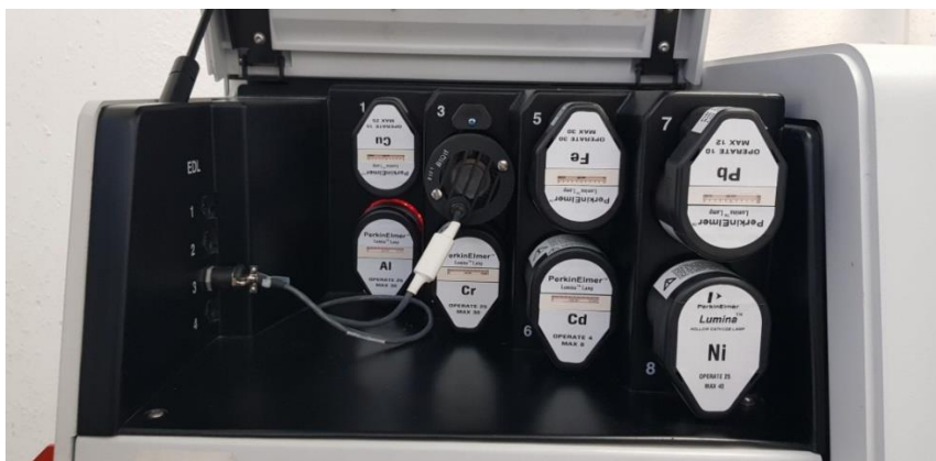
Slika 10. Žarulje u uređaju
