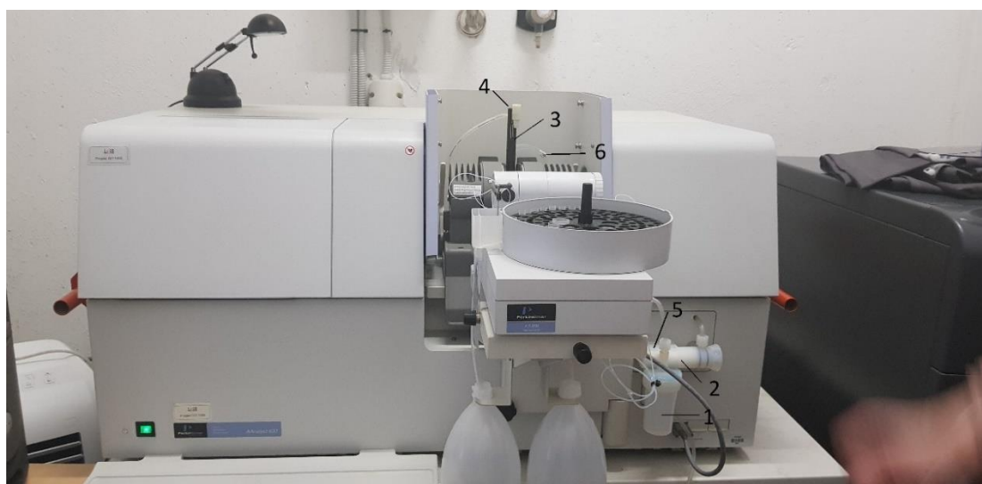
Slika 12. Dijelovi sustava za dovod plinova
