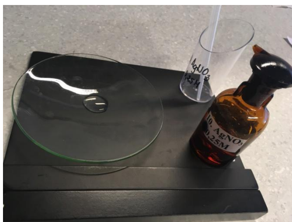
Slika 3.7. Negativna reakcija na kloride
