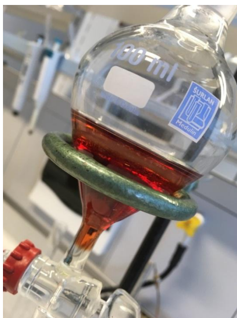
Slika 3.3. Prikaz razdvajanja organskog od vodenog sloja
