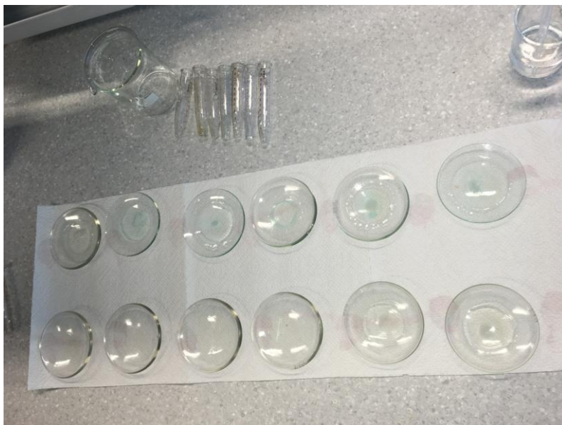
Slika 3.10. Slijedno dokazivanje iona kobalta
