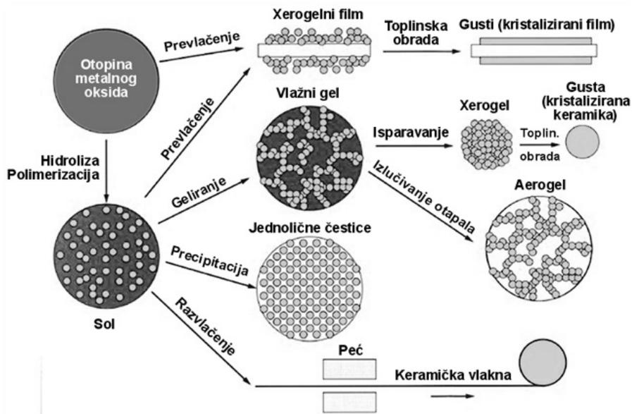
**Slika 4** Shema dobivanja različitih materijala sol-gel postupkom<sup>8</sup>
