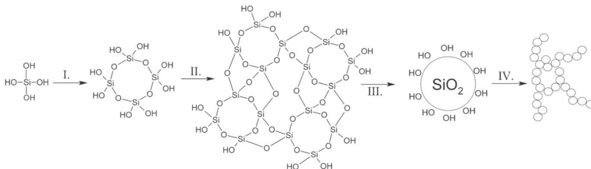
**Slika 6** Shema kondenzacije hidroliziranih silicijevih alkoksida: I.kondenzacija monomera u cikličke strukture, II. nastajanje trodimenzijskih SiO<sub>2</sub> čestica, III. rast SiO<sub>2</sub> čestica, IV. povezivanje čestica u neprekinutu trodimenzijsku mrežu<sup>6</sup>
