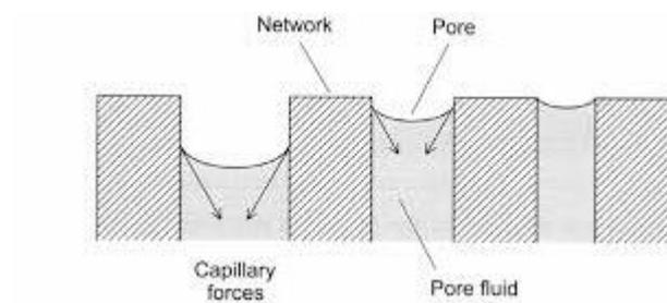
**Slika 8** Utjecaj kapilarnih sila na pore gela<sup>11</sup>
