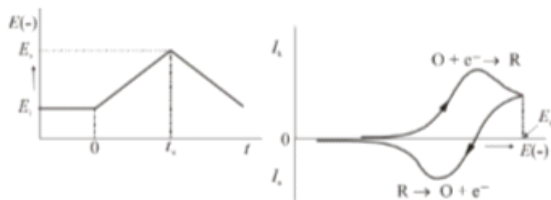
Slika 11. Signal pobude i signal odziva za cikličku voltametriju
