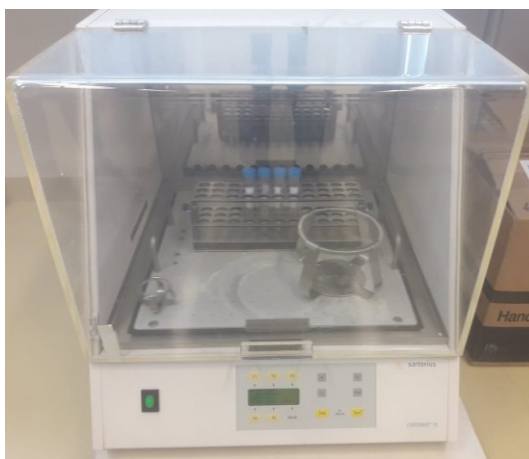
Slika 41. Inkubacija bakterijskih kolonija u tresilici
