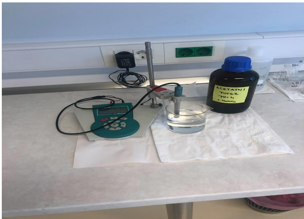
Slika 8. Aparatura za potenciometrijsko mjerenje
