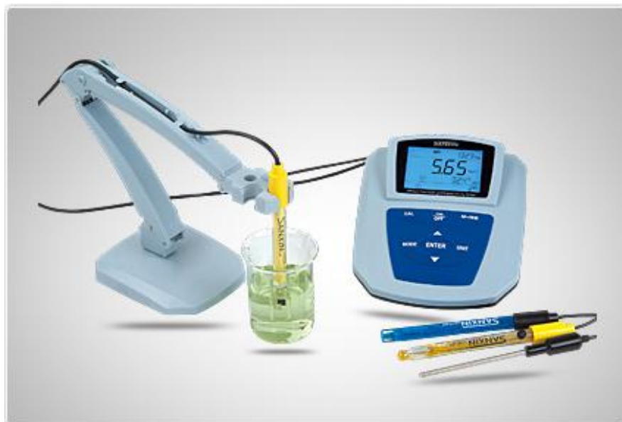
Slika 2. Prikaz različitih elektroda 5
