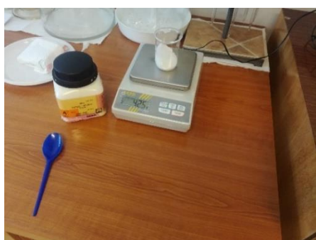
Slika 11. Priprema otopine 10%-tne NaOH
