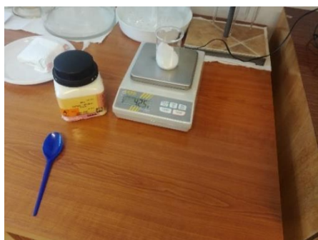
Slika 11. Priprema otopine 10%-tne NaOH
