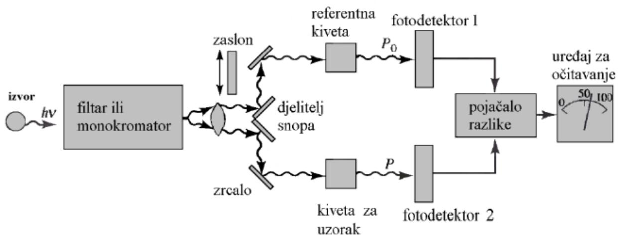
Slika 3.10. Shematski prikaz dvosnognog spektrofotometra s prostorno razdvojenim snopovima.
