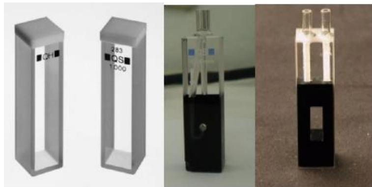
Slika 3.11. Kivete za spektrofotometrijska mjerena.
