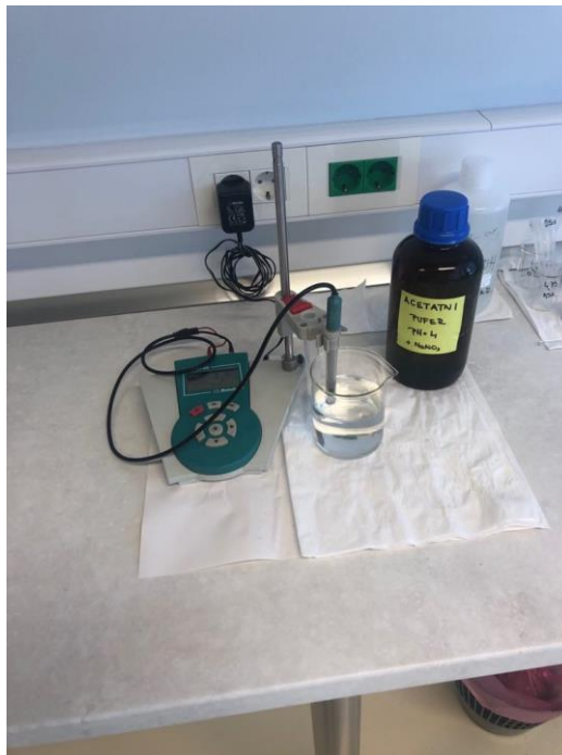
Slika 11. Priprava otopine acetatnog pufera i mjerenje pH vrijednosti.
