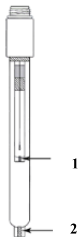
Slika 2. Dvojspojna referentna elektroda s prikazanim unutrašnjim (1) i vanjskim spojem (2). 5
