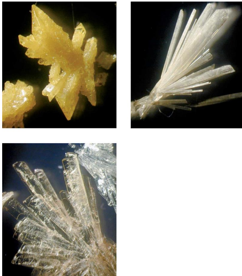
Slika 6. Kristali 1,3-bis( m -nitrofenil)ureje, MNPU - žute prizme ( \alpha oblik), bijele iglice ( \beta/\delta oblik) i žute pločice ( \gamma oblik) [1].
