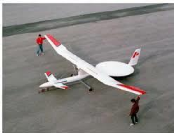
Slika 2.5. SHARP-ov avion na napajanje mikrovalovima. [25]
