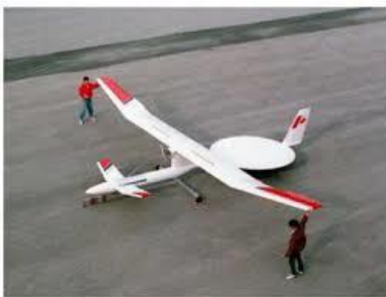
Slika 2.5. SHARP-ov avion na napajanje mikrovalovima. [25]
