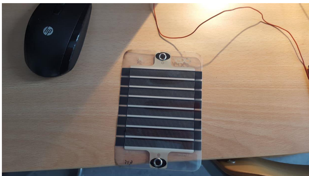
Slika 2.6. Modul izrađen od organske polimerne ćelije
