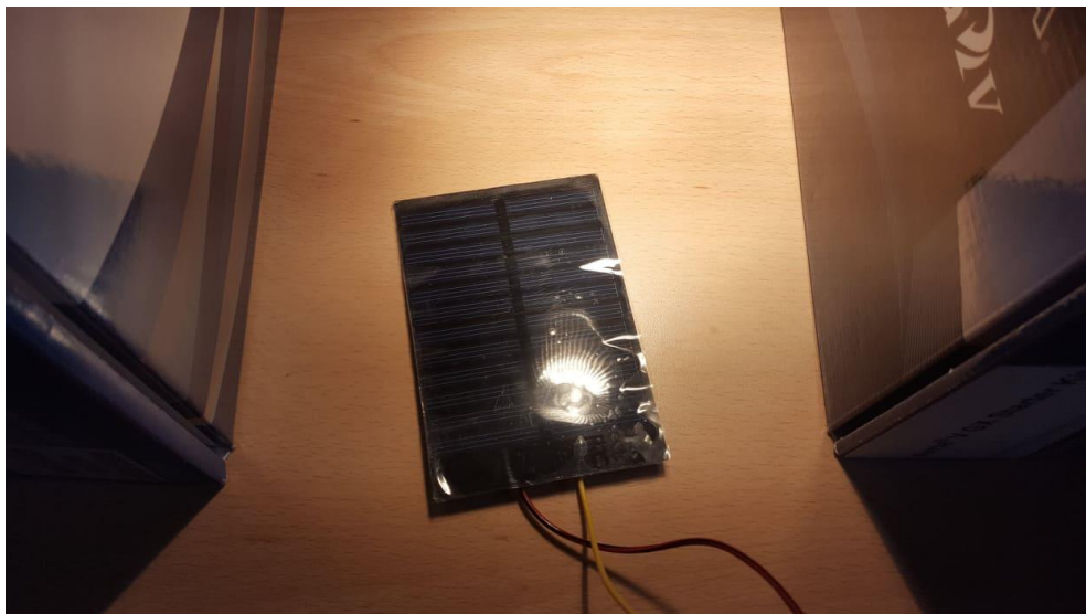
Slika 2.4. Modul izrađen od monokristaličnog silicija
