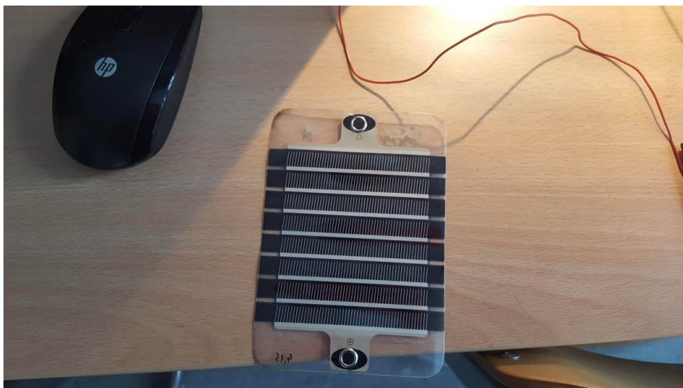
Slika 2.6. Modul izrađen od organske polimerne ćelije
