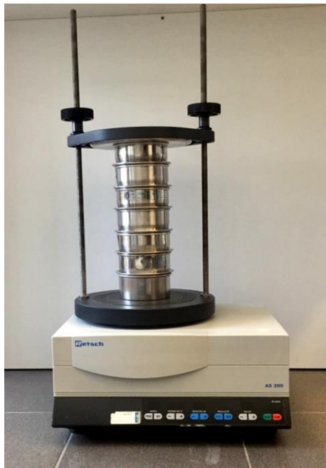
Slika 19. Aparatura za provedbu granulometrijske analize pomoću sita.
