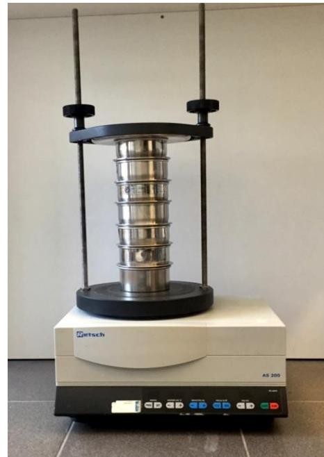
**Slika 19.** Aparatura za provedbu granulometrijske analize pomoću sita.
