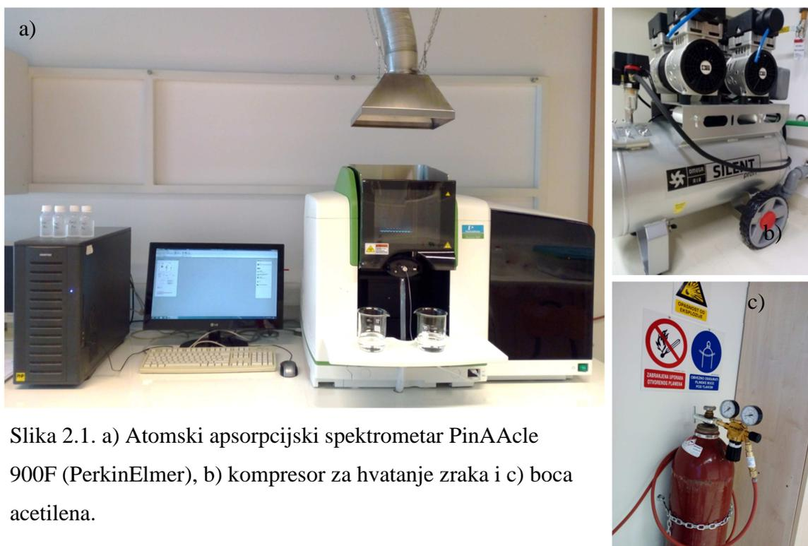
Slika 2.1. a) Atomski apsorpcijski spektrometar PinAAcle 900F (PerkinElmer), b) kompresor za hvatanje zraka i c) boca acetilena.
