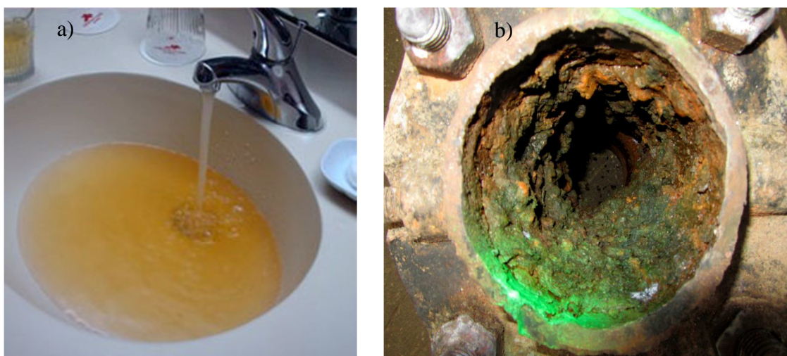
Slika 1.1. Problemi uzrokovani prisustvom Mn i Fe u vodi: a) „crvena voda“ i b) želatinozni talog unutar cijevi. 8,9
