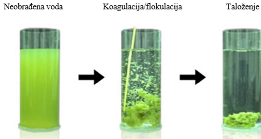
Slika 1.3. Izgled vode prije i nakon postupka koagulacije/flokulacije.<sup>16</sup>
