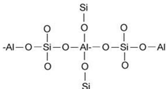
Slika 1.5. Osnovna struktura zeolita.<sup>19</sup>
