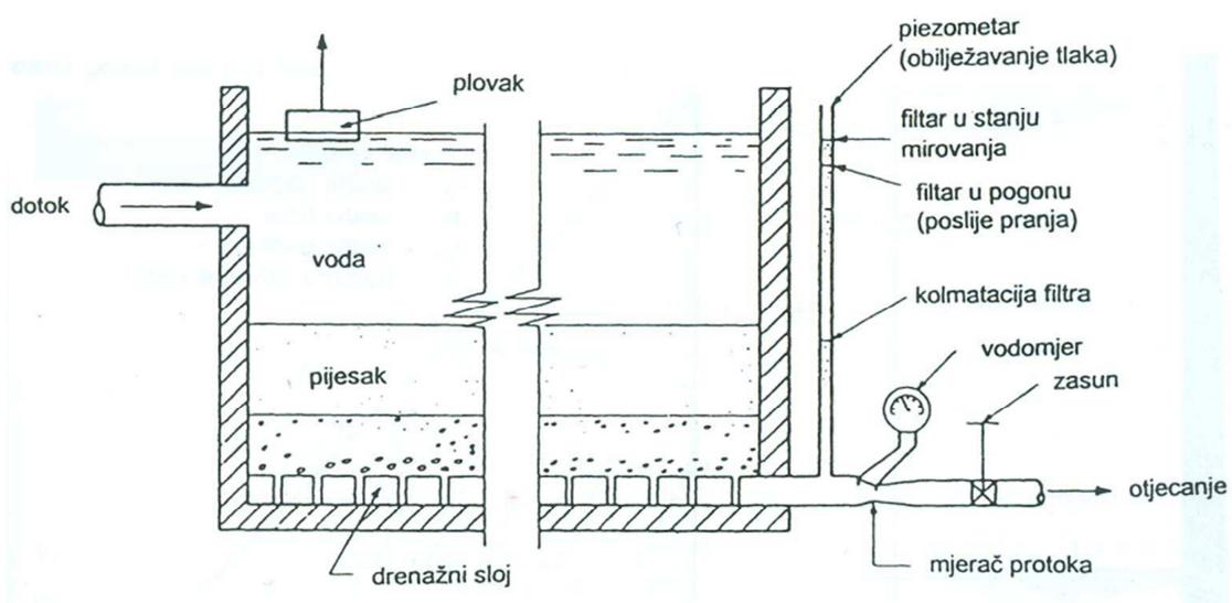
Slika 1.2. Shematski prikaz sporog filtra.<sup>15</sup>
