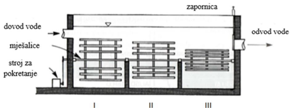
Slika 1.4. Shema reaktora za flokulaciju.<sup>16</sup>
