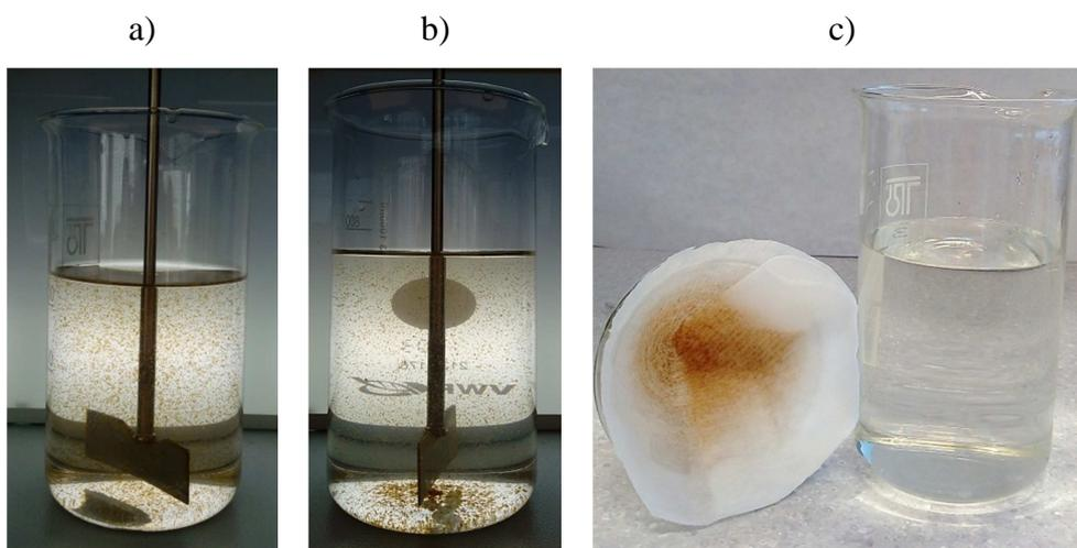
Slika 2.6. Učinak koagulanta/flokulanta 0,05% 815-C na taloženje nastalih čestica  $MnO_2$ : a i b) alkalizirana otopina mangana nakon dodatka koagulanta/flokulanta u Jar uređaju, c) zaostali talog  $MnO_2$  na filter papiru i filtrirana otopina mangana.
