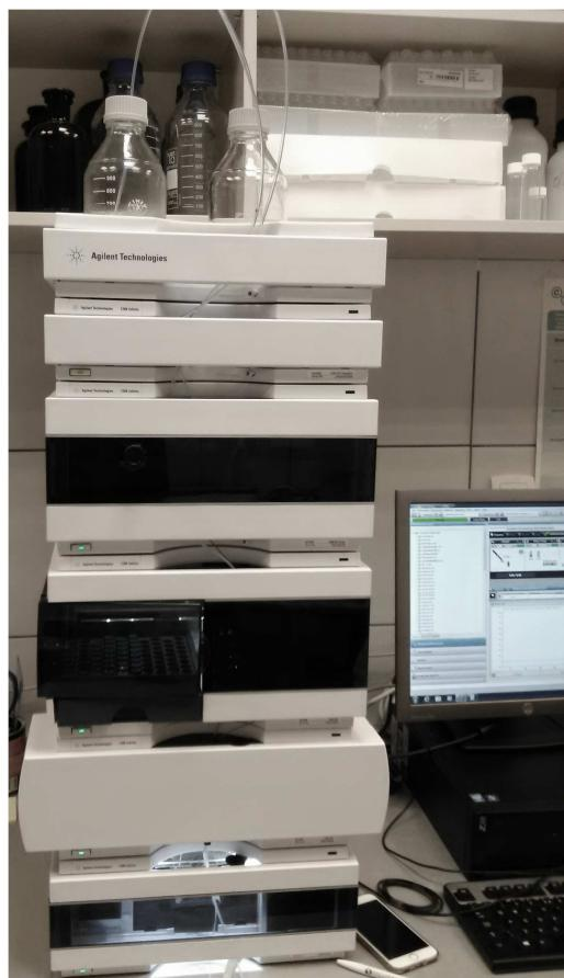
Slika 2.1. HPLC uređaj 1260 (Infinity Agilent).
