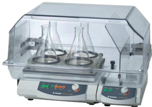
Slika 2.4. Laboratorijska tresilica „Heidolph Unimax 1010“.
