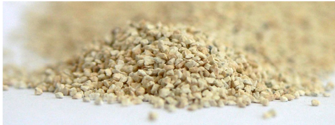
Slika 2.1. Uzorak zeolita klinoptilolita veličine čestica 0,6 - 0,8 mm.
