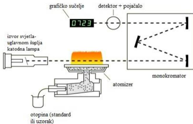
**Slika 13.** Princip rada atomskog apsorpcijskog spektrometra<sup>35</sup>
