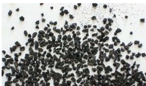
Slika 1.8. Granulirani aktivni ugljen. 30
