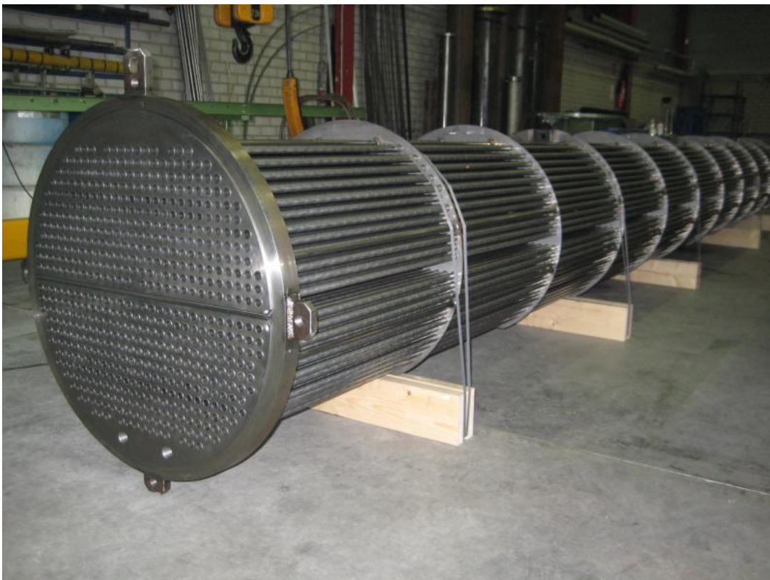
Slika 1.4. Izmjenjivač s učvršćenim snopom cijevi. 10
