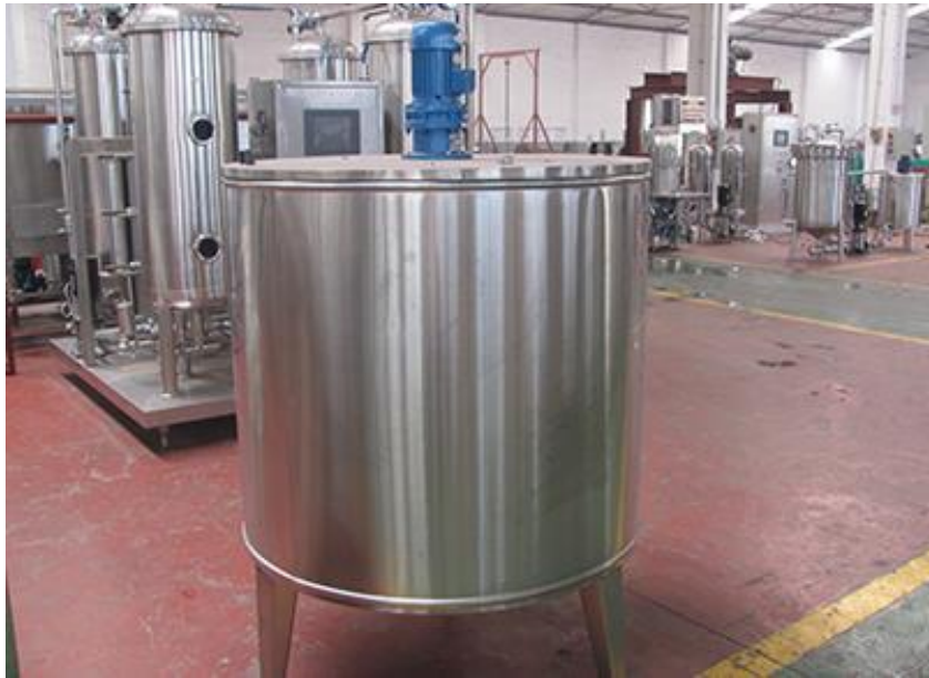
Slika 1. Uređaj za miješanje sirupa 12
