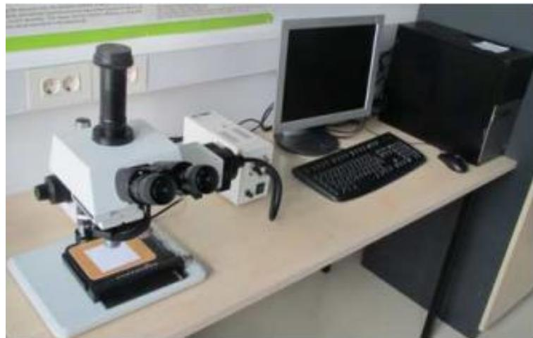
Slika 21. Optički mikroskop MXFMS-BD, Ningbo Sunny Instruments co.
