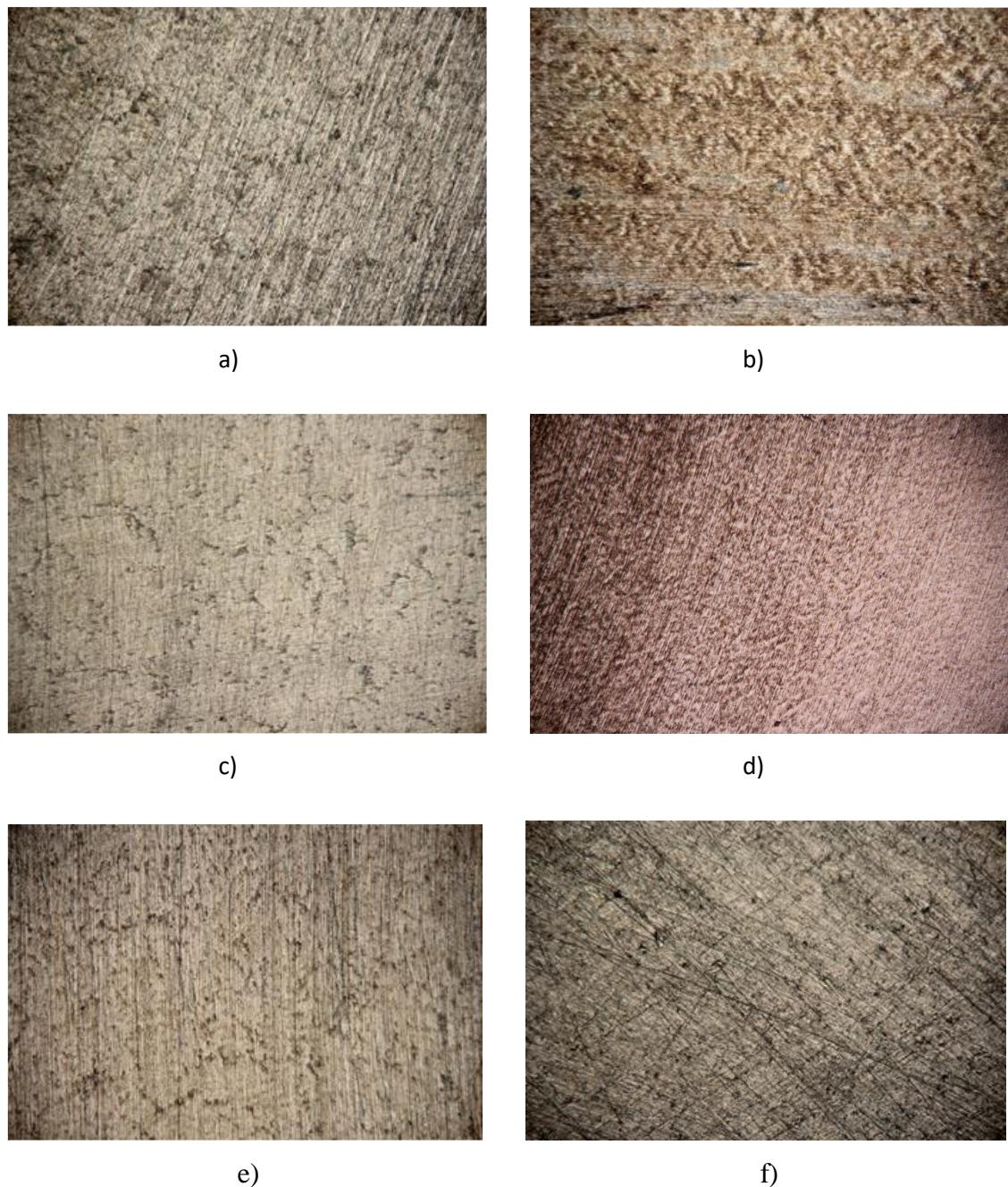
Slika 33. Mikroskopske snimke površine AA 5052 legure nakon potenciodinamičkih polarizacijskih mjerena u različitim otopinama gaziranih pića: a) Coca Cola, b) Pepsi Cola, c) Sprite, d) Fanta, e) Red Bull i f) Red Bull - Light
