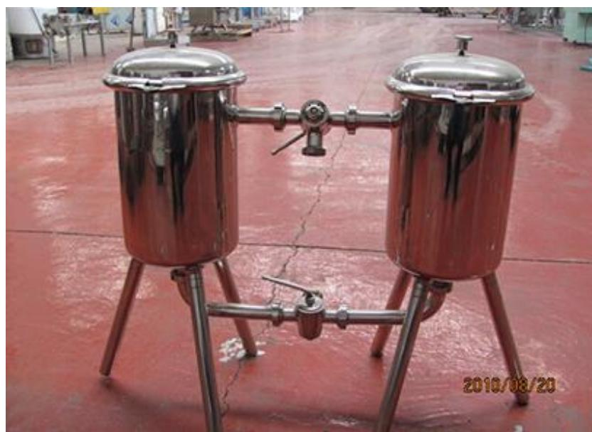
*Slika 2. Uređaj za filtraciju sirupa<sup>12</sup>*
