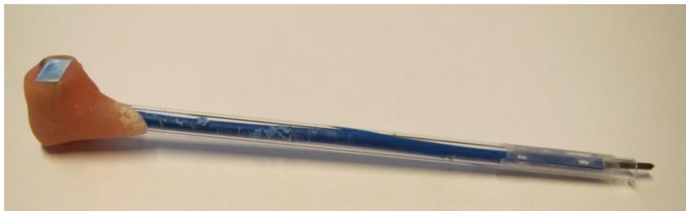
*Slika 17. Elektroda pripremljena za elektrokemijska mjerena*
