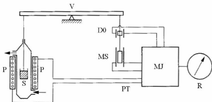
**Slika 8.** Shema TG instrumenta: V-vaga, S-uzorak, P-peć, MS-magnetski svitak za kompenzaciju mase, D<sub>0</sub>-detektor nulte točke, PT-programiranje temperature, MJ-modularna jedinica, R-registracijski uređaj
