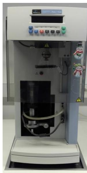
**Slika 10.** Termogravimetar Perkin-Elmer Pyris 1
