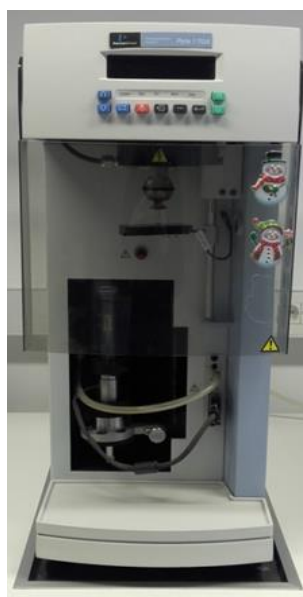
Slika 10. Termogravimetar Perkin-Elmer Pyris 1
