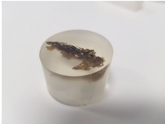
Slika 10. Uzorak alge Padina pavonica u epoksi smoli.
