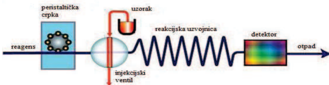
Slika 1-2 Shematski prikaz sustava za protočnu analizu injektiranjem. 9
