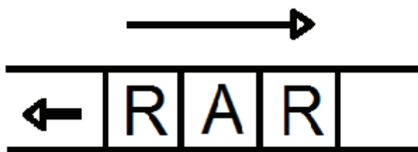
Slika 3-4 Shematski prikaz određivanja uz dvostrano injektiranje reagensa. Injektira se otopina reagensa, potom otopina analita te otopina reagensa.
