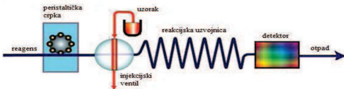
Slika 1-2 Shematski prikaz sustava za protočnu analizu injektiranjem. 9
