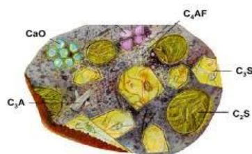
Slika 5. Slikovni prikaz poprečnog presjeka zrna cementa 5
