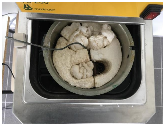
Slika 12. Prikaz mikrokalorimetrijske ćelije koja se nalazi u termostatu
