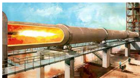
Slika 2. Rotacijska peć za proizvodnju PC klinkera 5
