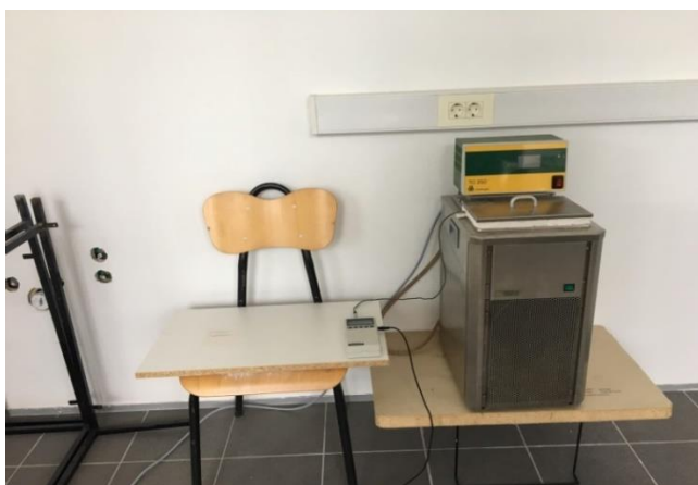
Slika 11. Aparatura za praćenje topline hidratacije
