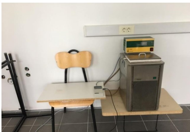
Slika 11. Aparatura za praćenje topline hidratacije
