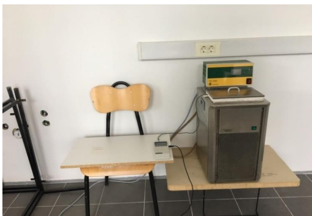
Slika 11. Aparatura za praćenje topline hidratacije
