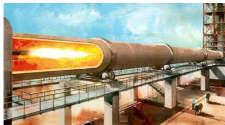
Slika 2. Rotacijska peć za proizvodnju PC klinkera 5
